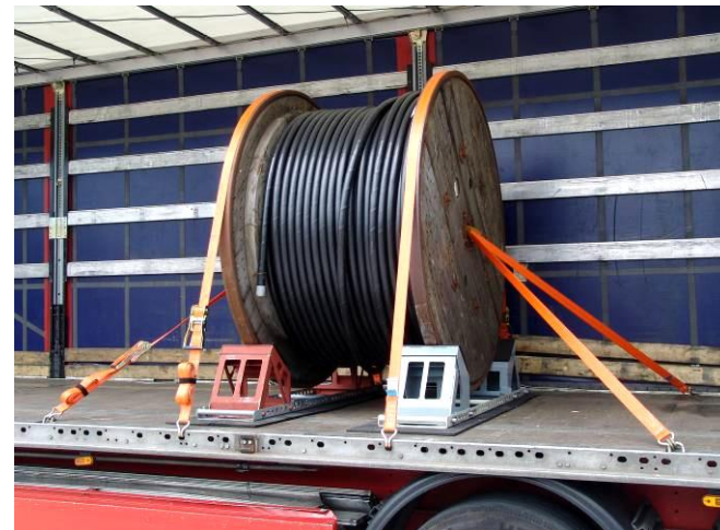
Das „GWS FlexSis 280“ Rollensicherungssystem ist hier quer zur Fahrtrichtung aufgebracht worden. Die Kabeltrommel wurde zusätzlich durch Kombination des kraft- und formschlüssigen Zurrverfahrens gesichert.
