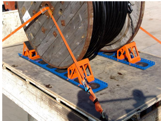
Der richtige Einsatz des „GWS FlexSis 280“ Rollensicherungssystems zur Sicherung einer Kabeltrommel
