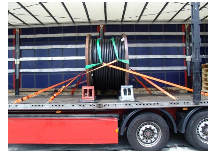
Mit Hilfe von zwei Rundschlingen wurde hier das Verfahren des Kopflaschings angewendet und durch das Diagonalzurren gesichert.
