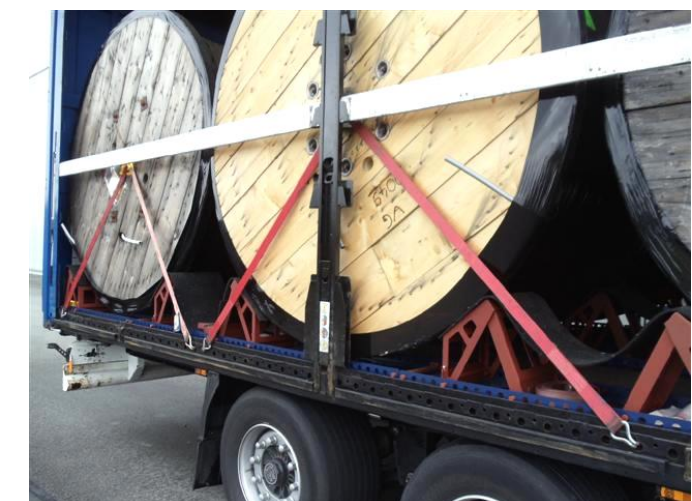
Das „GWS FlexSis 280“ Rollensicherungssystem – schnell, einfach und sicher!
